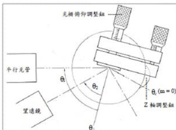
圖九 入射角 $>$ 繞射角的光路示意圖
