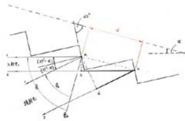
圖七 繞射光滿足反射條件光路圖
