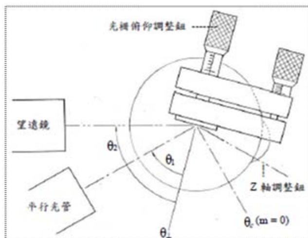
圖十 入射角 $<$ 繞射角的光路示意圖
