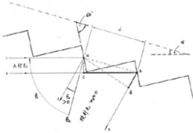
圖五 繞射效率較高光路圖
